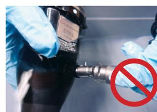
Течеискатель, погруженный в жидкость
