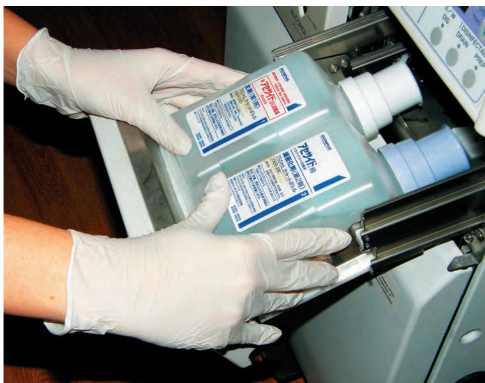
Автоматическое вскрытие кассет внутри машины и автоматическое разбавление раствора надуксусной кислоты до необходимой концентрации
