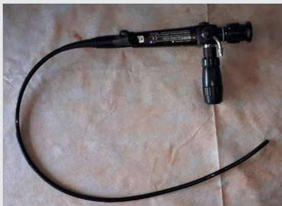
Рис. 1. Гибкий эндоскоп с автономным источником освещения
